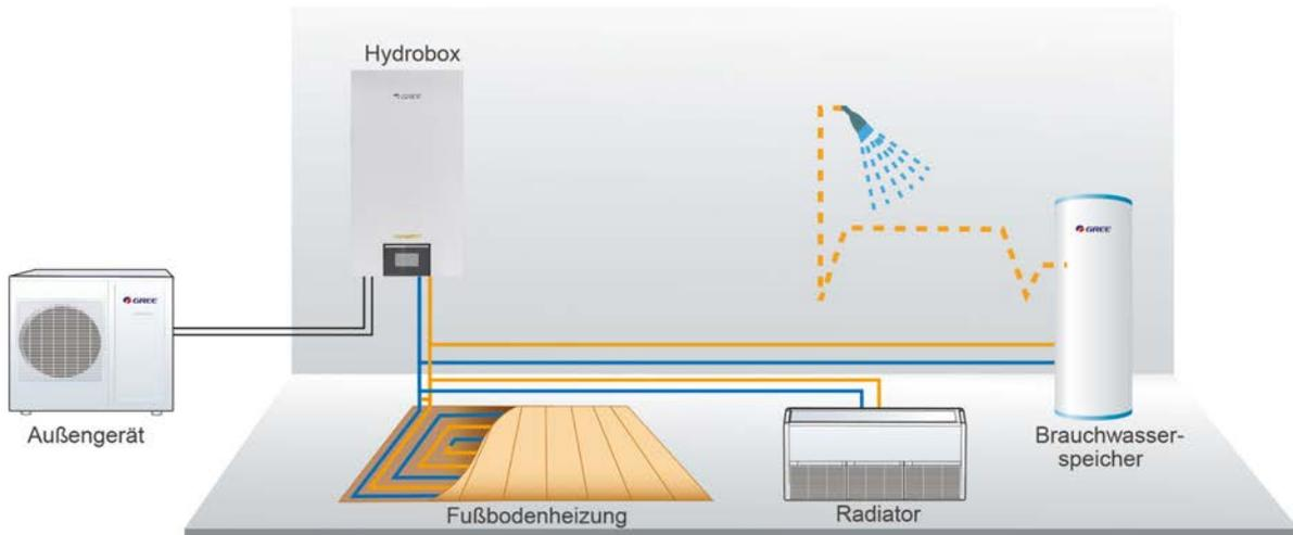
Beispiel 3: Heizen mit Fußbodenheizung (FBHZ) und Radiator und Kühlen (Fan Coils) mit Brauchwasserheizung
